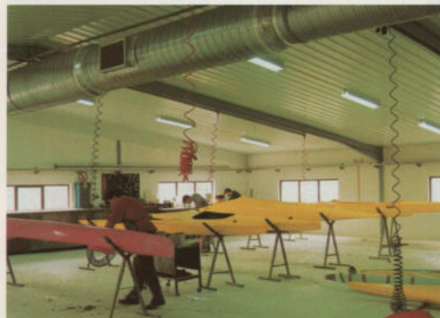
Aspecto da fase de polimento, já no 1º andar, onde podemos ver parte do sistema de renovação de ar que equipa toda a unidade fabril
